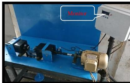
Gambar 4 Hasil pembuatan alat uji lelah
