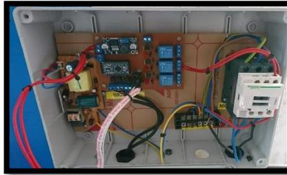
Gambar 2 Instalasi motor, sensor menggunakan mikrokontroler.
