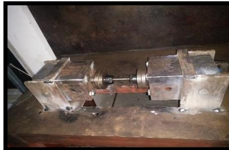
Gambar 6 Spesimen terpasang pada mesin uji lelah
